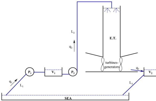
Fig. 2. Scheme of the ET plant.  $L_i$ : pipe  $i$ ;  $P_i$ : pumping station  $i$ ;  $V_i$ : reservoir  $i$ ;  $q_i$ : water discharge in pipe  $i$ .
